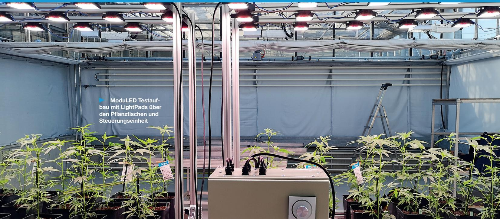
▶ ModuLED Testaufbau mit LightPads über den Pflanztischen und Steuerungseinheit
